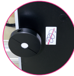
Manuelle Anpassung des Schnittwinkels Der Schnittwinkel X wird angepasst, um einen geraden und parallelen Schnitt zum Druck zu gewährleisten.
