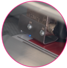
Erkennung von Markierungen Der Sensor erkennt die auf der Datei gedruckten Markierungen, um den Schnitt anhand dieser Markierungen auszulösen. Abgesehen von einer regelmäßigen Reinigung ist keine Wartung erforderlich.
