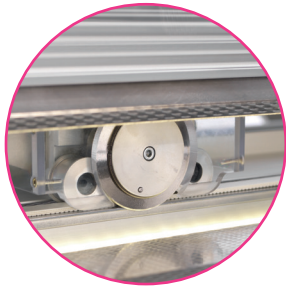
Selbstschärfende X-Klinge und Gegenklinge 2 Klingendurchmesser je nach Schneidgut erhältlich.
