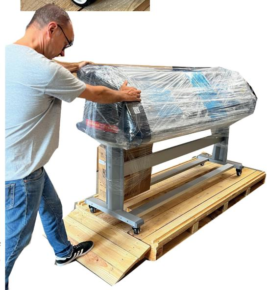
Sobald die Maschine frei auf der Palette steht, wird Sie über die Rampe auf den Boden gefahren
