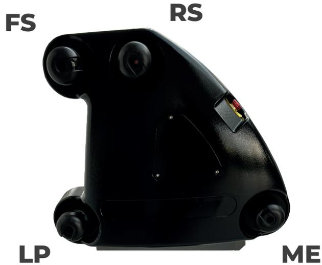
Die Bremsspannung ist für eine ordnungsgemäße Nutzung und Anwendung unerlässlich. Die beiden Positionen RS und FS sind miteinander verbunden, d.h. die Laminierfolie wird abgewickelt und der Liner wird aufgewickelt. Stellen Sie sicher, dass die Bremsknöpfe genügend Spannung aufbringen, um eine gleichmäßige Abwicklung der Schutzfolie auf den Kartonkern in der Position RS zu ermöglichen.
