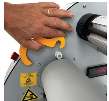
Wenn Sie die Walze in der oberen Position befindet, schwenken Sie den Haken an einem Ende und setzen Sie diesen wieder ein. Machen Sie das gleiche auf der anderen Seite.
