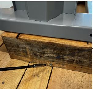
Schrauben Sie die Holzklötze an jeder Seite ab und entfernen Sie diese
