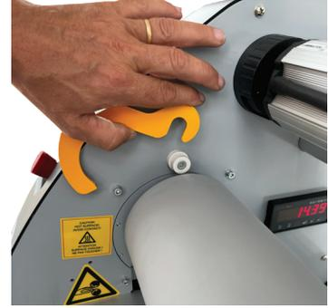
Wenn sich die Walze in der oberen Position befindet, schwenken Sie den Haken an einem Ende und nehmen Sie ihn aus dem Schlitz. Machen Sie das gleiche auf der anderen Seite.
