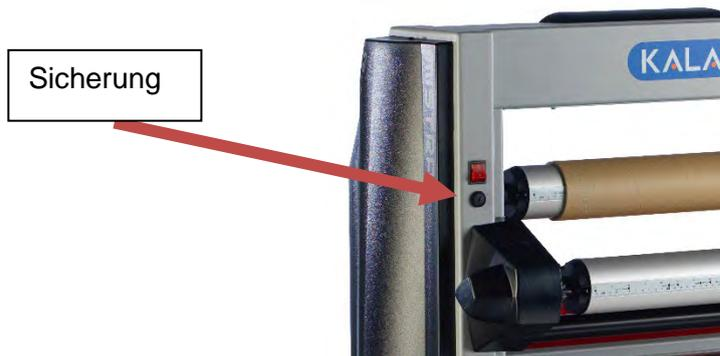
Austausch der Sicherung auf der elektronischen Leiterplatine:
