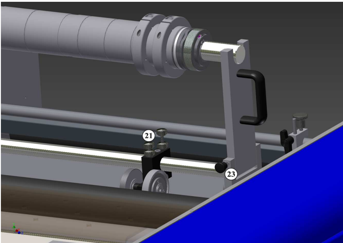
21. Einstellen des Perforier Regulierers 23. Aufspannbolzen Sperrvorrichtung
